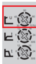
Рис.8 Потенциометры на панели управления УПП INNOVERT SSD, верхний потенциометр отвечает за установку начального напряжения, необходимое для исключения заклинивания ротора электродвигателя
