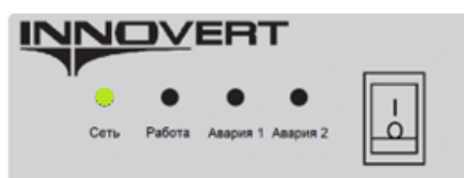
Рис.4 Индикатор «Сеть» о том, что напряжение приходит на плату управления УПП INNOVERT SSD
